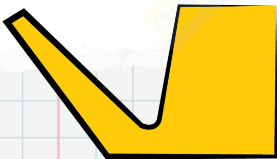
รูปหน้าตัด (Cross section) ของ V-Ring
